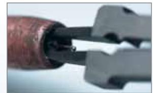
limpieza de la boquilla exterior de restos de material inyectado, por dentro y por fuera
