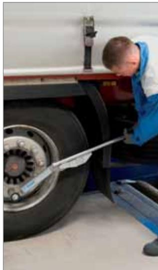
**267A****1/2" llave dinamoétrica con torque prefijado**
