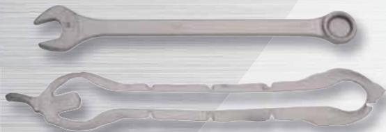
**3. corte:** la eliminación del material restante alrededor de la pieza se lleva a cabo con herramientas de corte especiales. La eliminación de fragmentos, hasta lograr la forma deseada, se realiza de modo tal, que el peso de las partes cortadas es menor que el peso de la pieza forjada;
